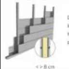
Durch den freien Raum zwischen Innen- und Außenwand ist es möglich, Isolierungen und Versorgungsleitungen problemlos zu integrieren!
