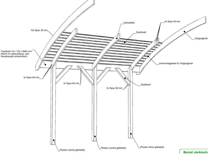
Die Pfosten werden mit Überlänge geliefert und müssen bauseits nach den örtlichen Gegebenheiten angepaßt werden!
