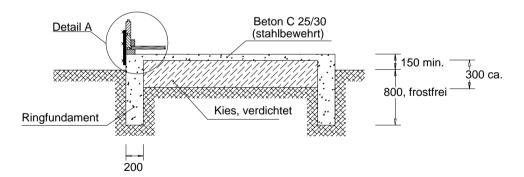
Auf das Fundament ist eine Feuchtesperre aufzubringen (Pappe oder Folie).
