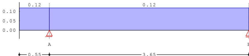
Eigengewicht  $0.04\text{m} * 0.14\text{m} * 5.00\text{kN/m}^3 = 0.031\text{ kN/m}$
