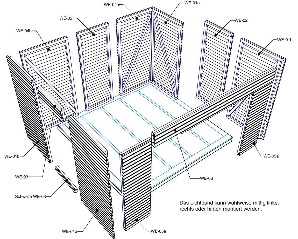
Das Lichtband kann wahlweise mittig links, rechts oder hinten montiert werden.
