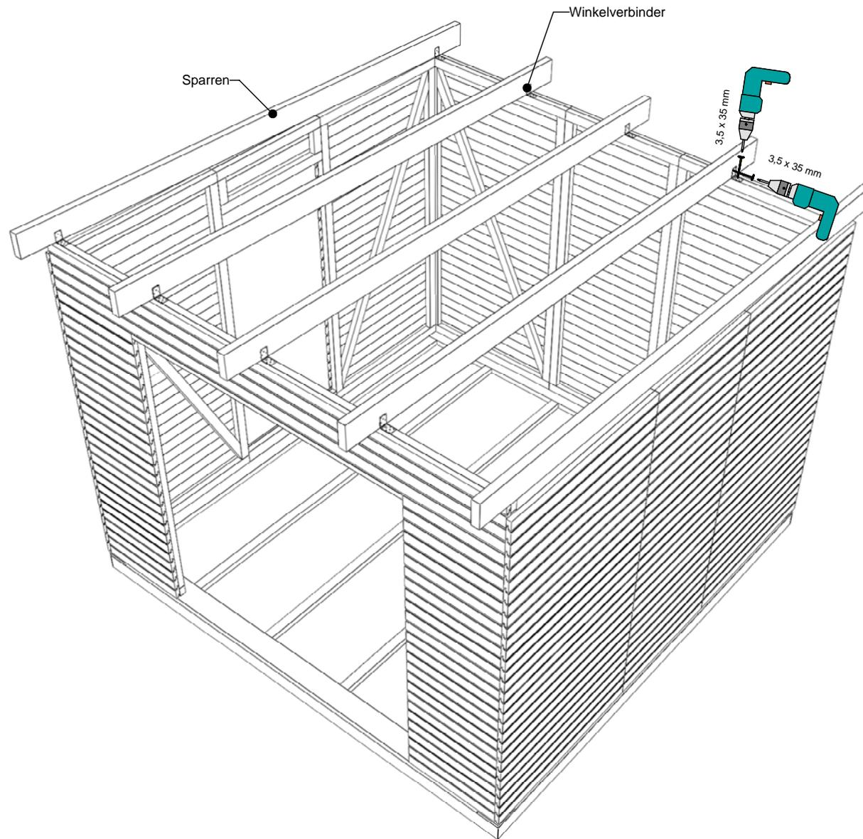
Die Sparren sind nach Sparrenplan auf den Wandelementen der Vorder- u. Rückwand zu befestigen.
