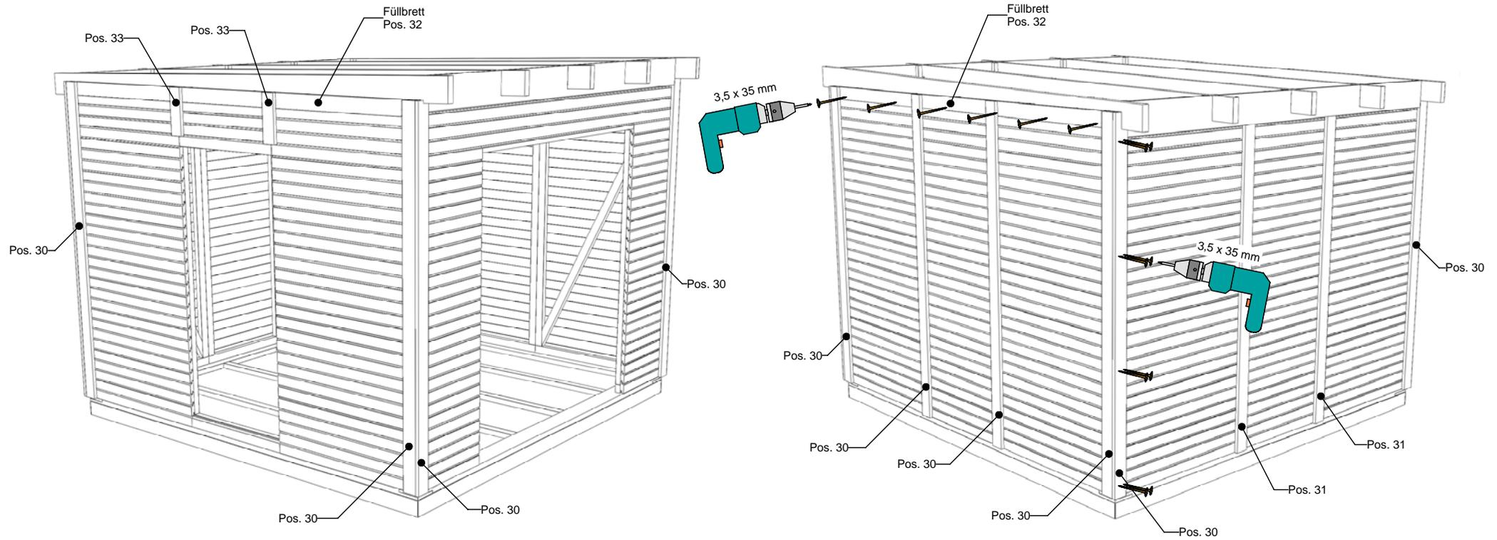
An den Seiten werden oberhalb der Wandelemente Füllbretter befestigt.
