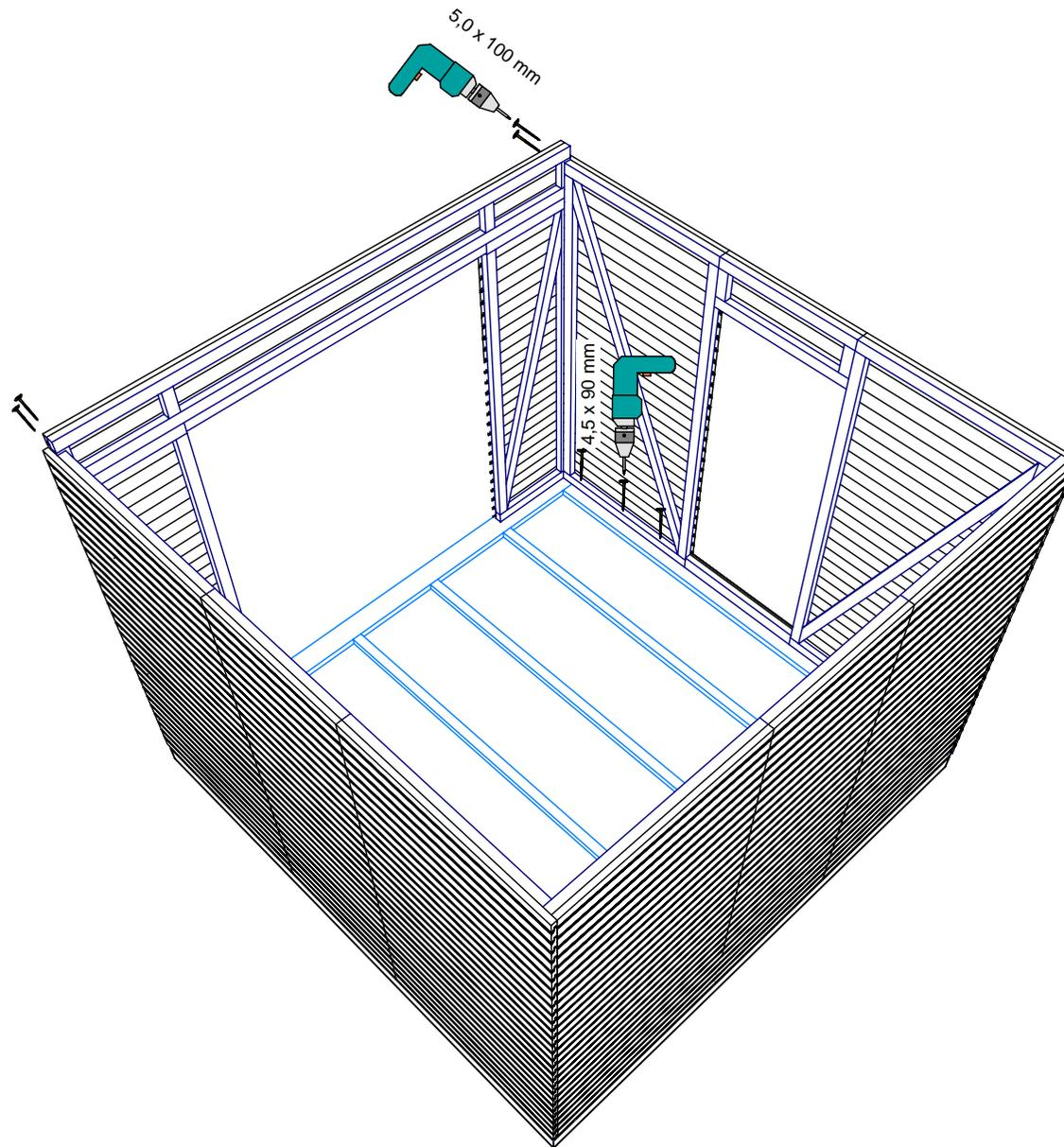
Wenn alle Wandelemente verschraubt und exakt ausgerichtet sind, werden sie auch mit den Bodenriegeln verschraubt.
