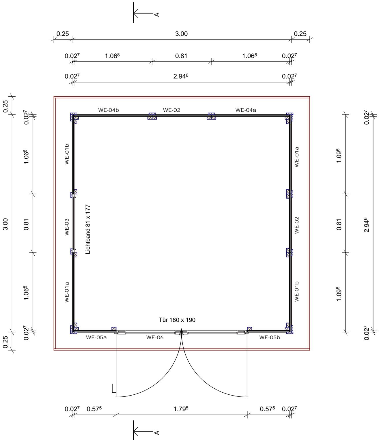
Das Lichtband kann mittig links, rechts oder hinten eingesetzt werden.
